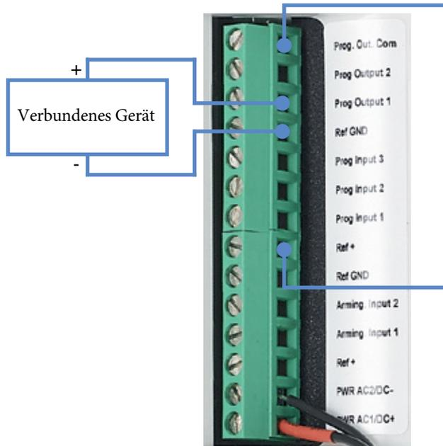
Die durch Ref+ zugeführte Stromversorgung ist begrenzt (gleich dem AC/DC-Netzteil). Diese Verkabelung kann nicht verwendet werden, um ein Gerät mit Strom zu versorgen, jedoch als Spannungsquelle. Falls das Gerät mit Strom versorgt werden muss, ist ein externes Netzteil erforderlich:
