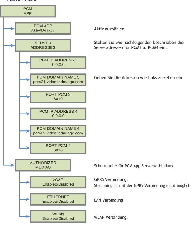
Um zu prüfen ob die PCM Verbindung korrekt funktioniert, geben Sie im Standby Bildschirm folgenden Code ein: 999986+YES/OK.
