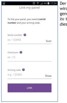
Der Schärfungscode wird am Bedienteil genutzt um die Anlage zu schärfen. Geben Sie diesen Code hier ein.
