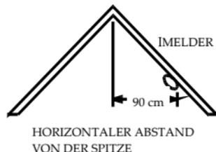
Abbildung 4: Empfohlener Einbauort für Rauch- und Hitzemelder in Räumen mit geneigten Decken oder Giebeln (Neigung >20 Grad).
