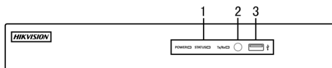
Figure 1. 2 Vorderseite beim DS-7204/7208HGHI-SH
